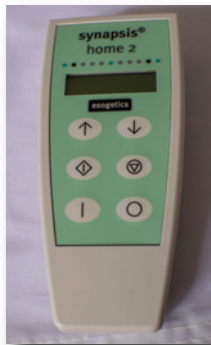
Abb. 7: Synapsis home 2 Gerät von oben mit den Tasten
